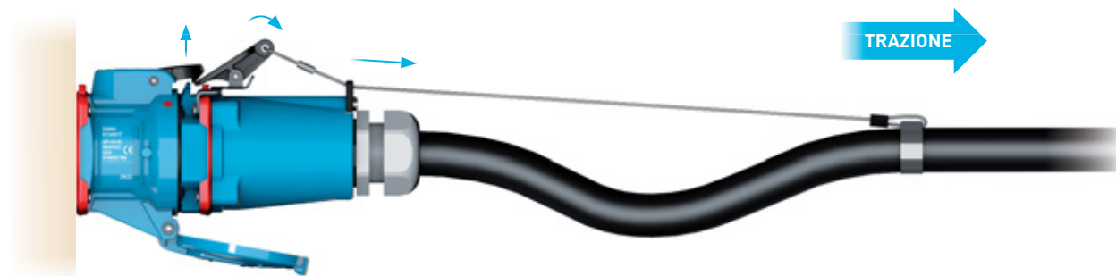
Fase 2: La trazione del cavo si trasmette al filo d'acciaio. Il meccanismo si solleva progressivamente andando a sollevare il gancio della presa.
