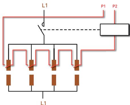
**SCHEMA DI DISTRIBUZIONE DELL'ENERGIA CON CONTATTI PILOTA COLLEGATI IN SERIE PER IL COMANDO DELL'INTERRUTTORE A MONTE**
